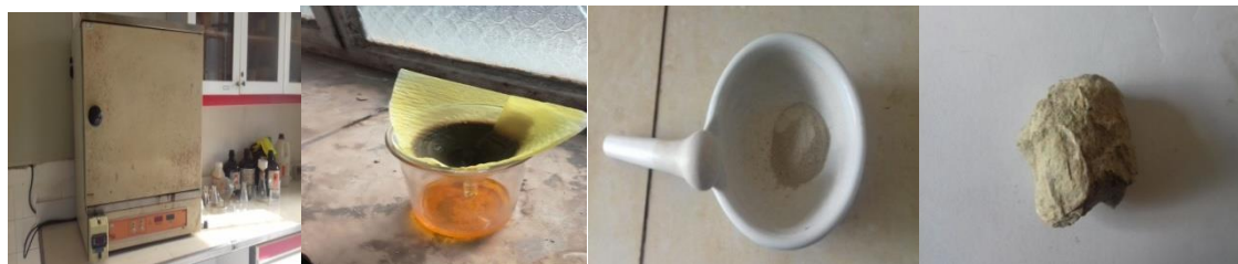
اشکال ۱۴، ۱۵، ۱۶ و ۱۷: به ترتیب از سمت راست نمونه سنگ مورد آزمایش، سنگ پودر شده، پودر مخلوط با اسید کلریدریک رقیق و دستگاه آون جهت خشک کردن نمونه رسوب پودر شده در آزمایشگاه رسوب شناسی
