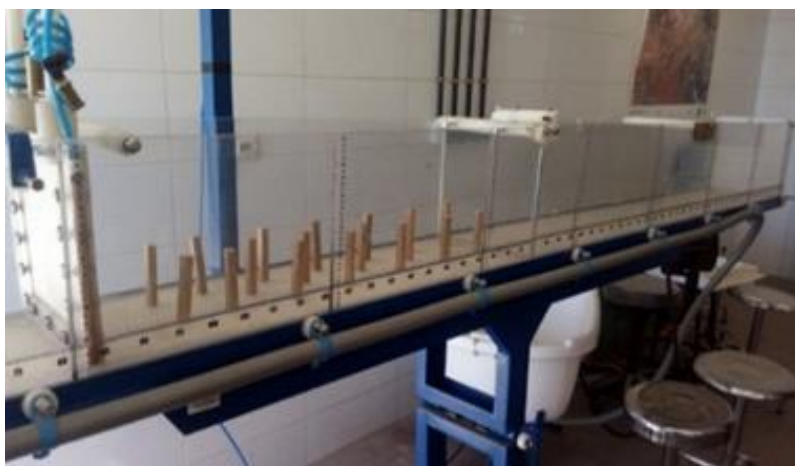
شکل ۴: کانال آزمایشگاهی جهت شبیه‌سازی
