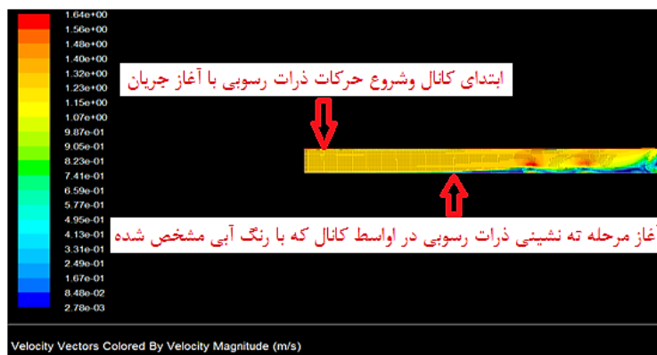
شکل ۱۰: نتایج شبیه‌سازی ته‌نشینی ذرات رسوبی در فواصل مختلف کانال آزمایشگاهی (رنگ آبی مشخص‌کننده ذرات رسوبی با قطرهای ۰/۱ الی ۰/۴ میلی‌متر هستند)
