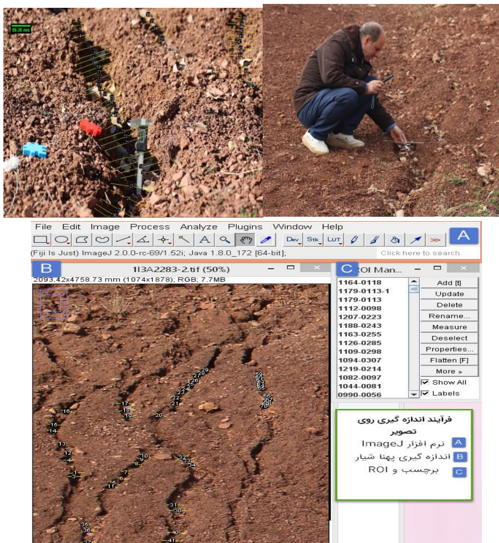
شکل ۲: تصویر بالا سمت چپ، اندازه‌گیری مستقیم پهنا و عمق شیار؛ تصویر بالا سمت راست مقیاس گذاری و اندازه‌گیری روی تصویر شامل پهنای شیارها، طول سایه دیواره؛ تصویر پایین پردازش تصویر در نرم‌افزار ImageJ
