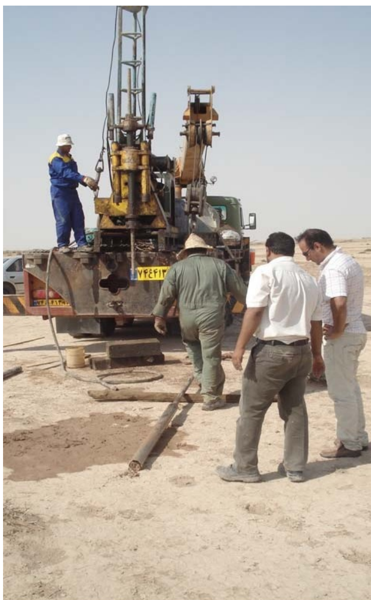
شکل ۴. مغزه‌برداری با مته دورانی در منطقه جفیر
