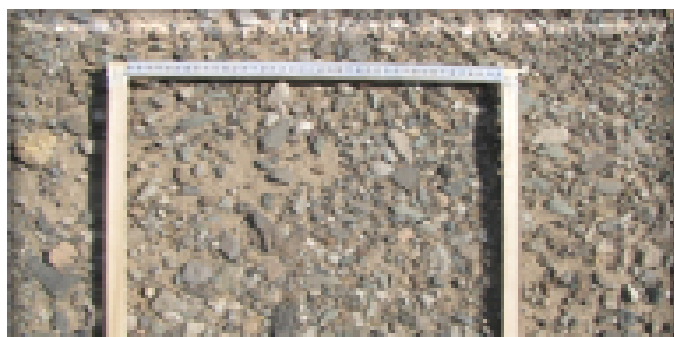
شکل ۴- نمونه برداری از سنگ‌فرش بیابانی در تیپ دشت‌سر لخت
