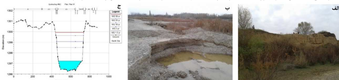
شکل ۱۳: الف: کناره‌های پرتگاهی رودخانه در بازه (۳)؛ ب: نوع رسوبات در بالادست این بازه. برداشت نظارت‌نشده شن و ماسه در بازه (۳) باعث آشفستگی، عریض شدگی و گودافتادگی مجرای رودخانه در اغلب قسمت‌ها شده است؛ ج: مجرای عریض و گود افتاده باعث انفصال کریدور رودخانه و دشت سیلابی شده است. همچنان که دیده می‌شود، حتی یک سیلاب با دوره بازگشت ۵۰ ساله نیز قادر به پر کردن مقطع عرضی مجرای رودخانه نیست.
