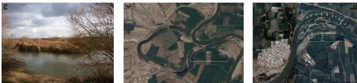
شکل ۱۴: الف: احداث دایک‌ها در جهت مقابله با مهاجرت جانبی مناندر در بازه (۴). برداشت ماسه از پشت‌های رسوبی کناره‌های محدب مناندرها به روشنی قابل مشاهده است؛ ب: میان‌بر گلوگاهی و تشکیل برکه نعل‌اسبی؛ ج: دست‌اندازی پوشش گیاهی به مجرای رودخانه در پایین دست میان‌دوآب
