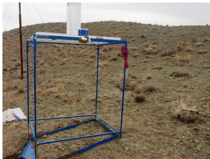
شکل ۳: تصویری از دستگاه شبیه‌ساز باران مورد استفاده برای انجام آزمایش‌ها در حوضه آبخیز سد کاخک
