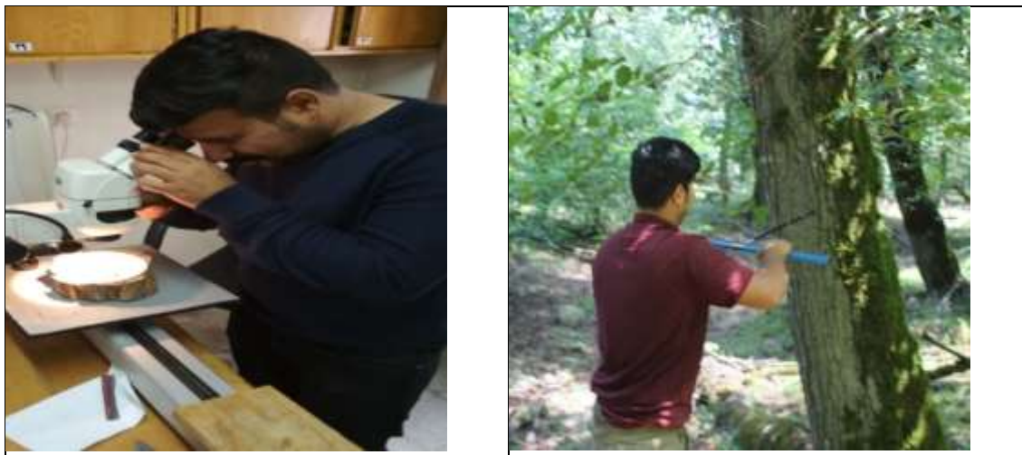
شکل ۲: نمونه مغزه با استفاده از منته رویش سنج شکل ۳: دستگاه لین تب برای اندازه گیری پارامترهای ماکروسکوپی
