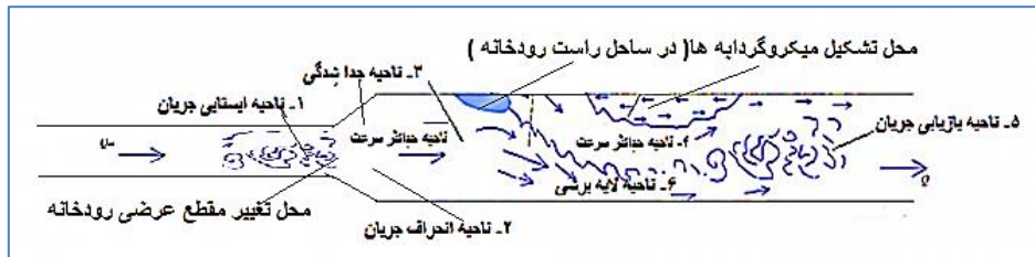
شکل ۱۳: تصویر شماتیک از نواحی تفکیک شده در محل تغییر مقطع عرضی آبراهه و تلاقی رودخانه واگرا به بسترهمگرا)
