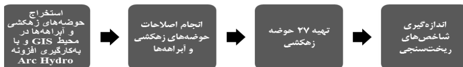
شکل ۴: مراحل تهیه حوضه‌ها و آبراهه‌ها به منظور اندازه‌گیری شاخص‌های ژئومورفولوژی.
