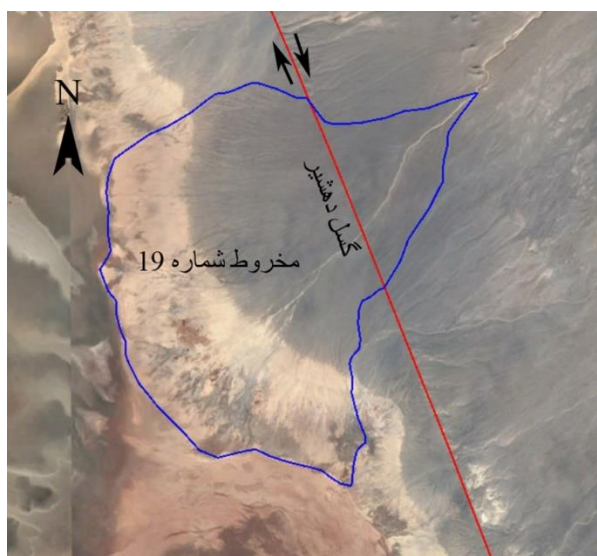
شکل ۷: تأثیر حرکت امتدادلغز گسل دهشیر در جابجایی عرضی و بی‌قوارگی مخروط شماره ۱۹
