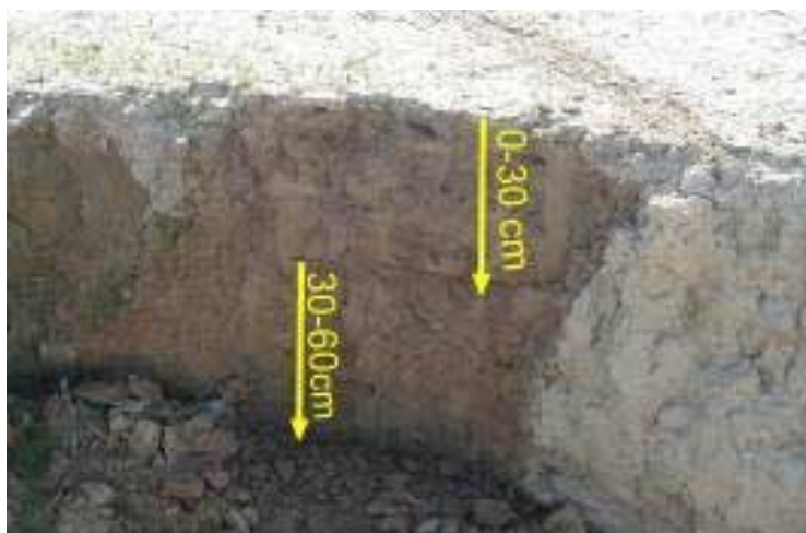
شکل ۴. روش نمونه‌برداری از دیواره خندق
